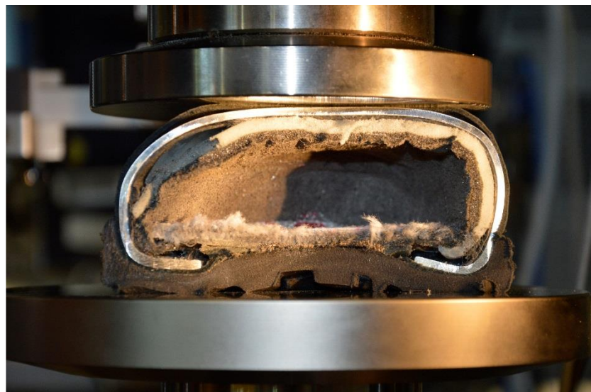
Abb. 6: Druckversuch nach ISO 20344 – hier 5 kN
