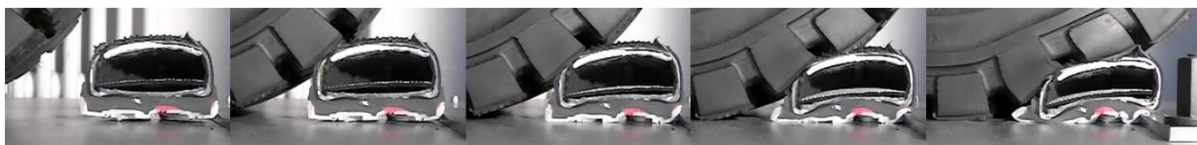
Abb. 5: Abtauchen der Zehenschutzkappe in die Laufsohle unter steigender Druckbelastung beim Überrollen (Schlussbericht zu AiF-Projekt 17636)
