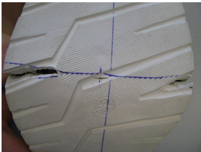
Abb. 3: Sohlenbruch nach Dauerbiegeprüfung im PFI-Labor
