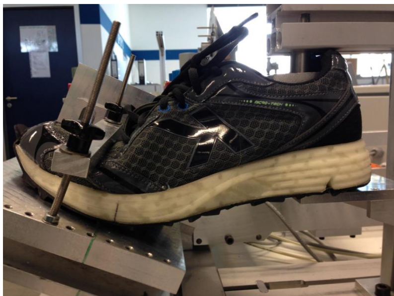
Abb. 1: Die im EU-Forschungsprojekt ADDFactor im Jahr 2014 per 3D-Druck hergestellte Laufsohle eines Sportschuhs auf einer PFI-Flexibilitätsprüfmaschine im Dauertest
