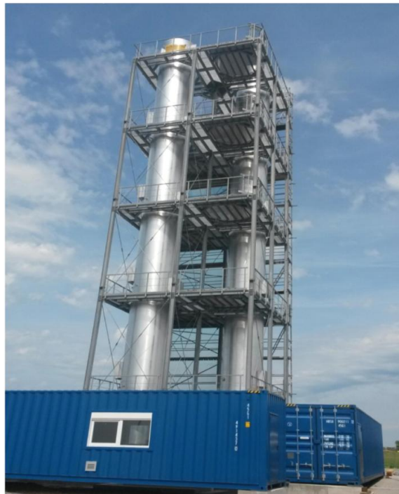
PFI-Technikumsanlage zur Methanisierung und Power-to-Gas Pilotanlage im Energiepark
